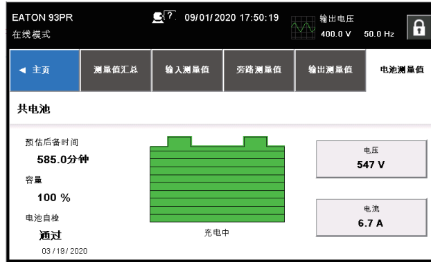
图6-22: 铅酸电池测量值屏幕
