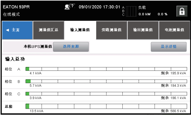
图6-10: 输入测量值屏幕
