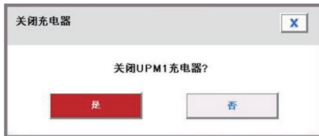
图6-31：充电器关闭指令确认屏幕
