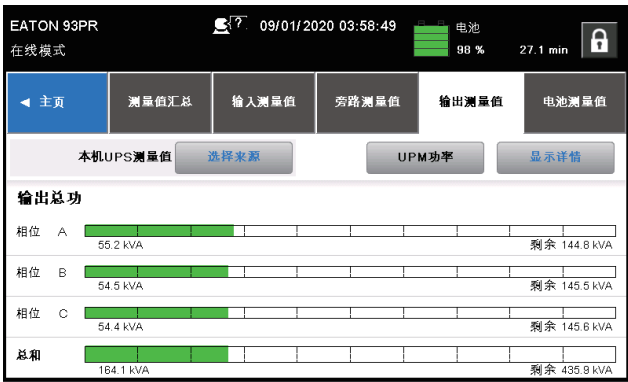
图6-18：输出测量值屏幕
