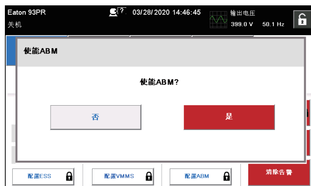
图6-35：使能高级电池管理(ABM)指令确认屏幕
