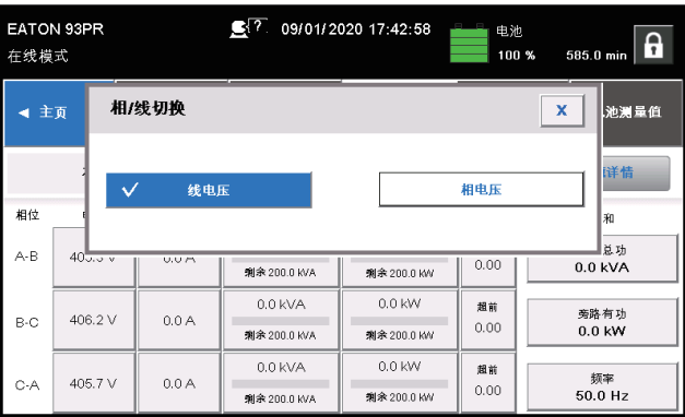
图6-16: 选择电压显示模式屏幕
