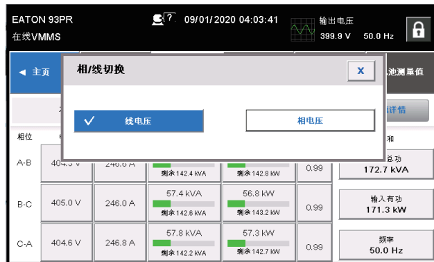
图6-12：选择电压显示模式屏幕
