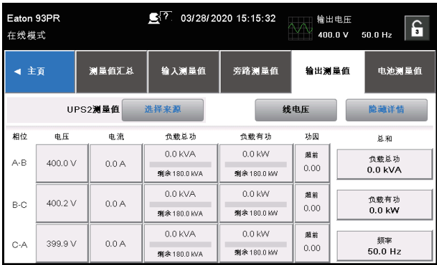
图6-21： 输出测量值详情屏幕
