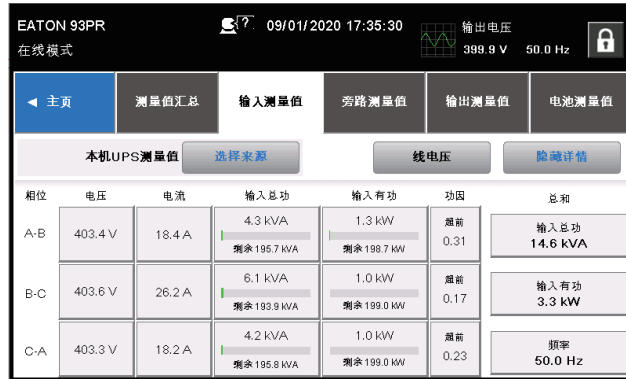
图6-11：输入测量值详情屏幕
