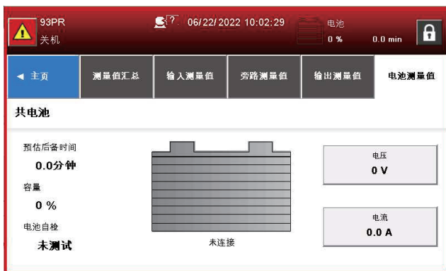
图6-25: 锂电池测量值屏幕
